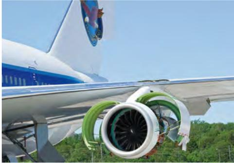
Die Flugerprobung des PW1500G erfolgte an Bord der werkseigenen Boeing 747SP
