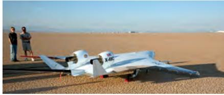
der X-48C konnte zudem gezeigt werden, dass sich durch die Anordnung der Triebwerke über dem Rumpf die Abstrahlung des Lärms nach unten abschirmen lässt. Der Testserie mit der X-48C gingen insgesamt 92 Flüge mit dem dreistrahligen Vorgänger X-48B voraus.
